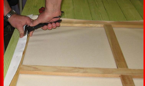
Bij het opspannen van grotere doeken wordt gebruik gemaakt van een spantang en een nietentacker. Let ook op de hier toegepaste kruislatten.
